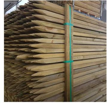
La madera recibe un **tratamiento de sales hidrosolubles** en autoclave vacío-presión. La madera seca (con una humedad inferior al 28%) se introduce en el autoclave, que es un cilindro metálico cerrado donde se van a producir los cambios de presión y la inyección de los productos. En primer lugar, se aplica un vacío inicial para extraer el aire que haya en la estructura de la madera. Después se inyectan las sales hidrosolubles a alta presión para obtener mayor absorción.
